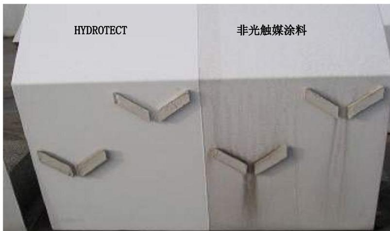
图 10 加硅胶密封后的曝露实验（户外曝露，期间：1 年）
